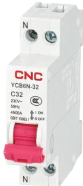
适用于交流50Hz，额定电压230V以下的单相住宅线路中，对电气线路进行过载和短路保护。该产品分断能力高、体积小、宽度仅为18mm。零、火线同时切换，杜绝了火线、零线接反或零线对地电位造成的人身及火灾危险，是目前民用住宅领域中最理想的配最保护开关。
